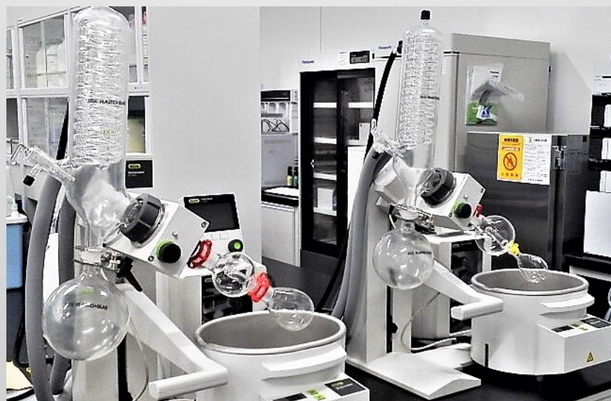
ロータリーエバポレーター 有機系のラボには必ずあります。 溶媒を取り除くための装置。
