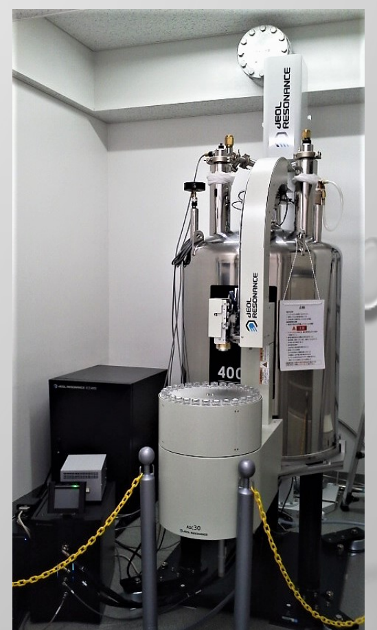
核磁気共鳴装置 (NMR) 有機化合物の構造を決定する のになくてはならない装置。
