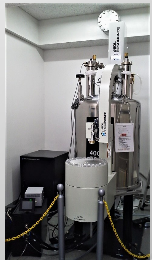
核磁気共鳴装置 (NMR) 有機化合物の構造を決定する のにはなくてはならない装置 (本装置は別室となります)
