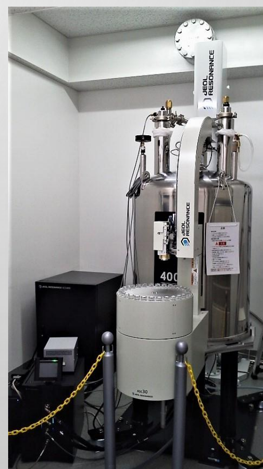
核磁気共鳴装置 (NMR) 有機化合物の構造を決定するための装置 (本装置は別室となります)
