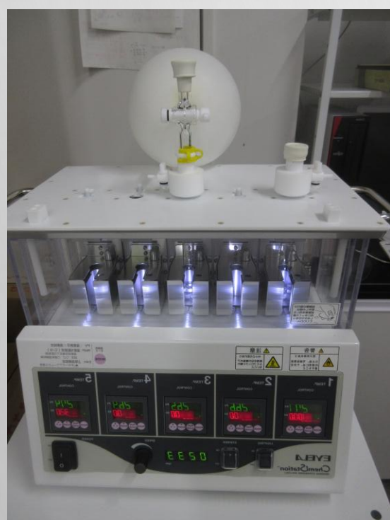
パーソナル有機合成装置 同時に複数の化学反応を実施できる装置
