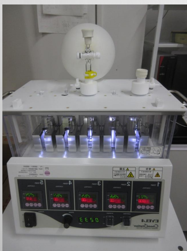
①パーソナル有機合成装置 同時に複数の化学反応を 実施できる装置
