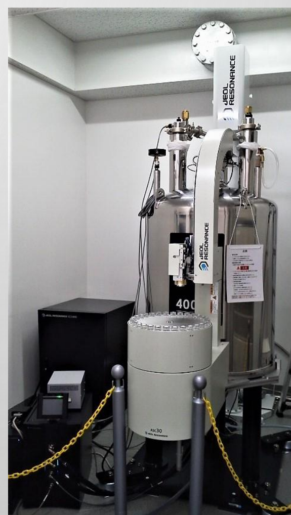
核磁気共鳴装置 (NMR) 有機化合物の構造を 決定するための装置 (本装置は別室となります)
